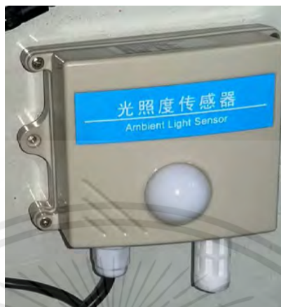
รูปที่ 2.7 อุปกรณ์ตรวจวัดค่าแสง (Light Sensor)
