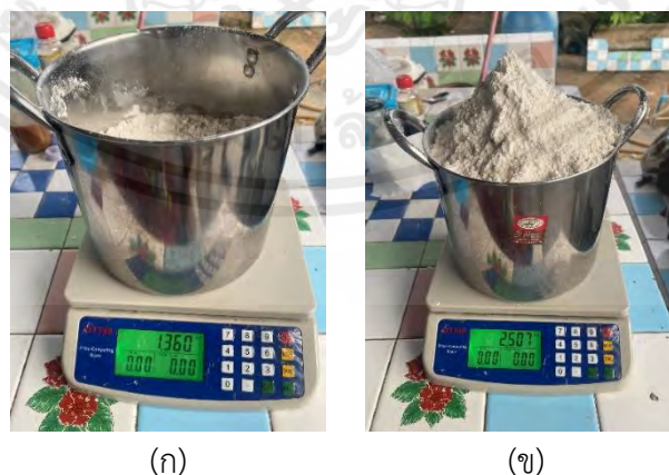
รูปที่ 4.3 การชั่งน้ำหนักแป้งที่ปล่อยออกมาตามโหมคน้ำหนัก (ก) น้ำหนักแป้งที่ได้จากโหมต 1 กิโลกรัม (ข) น้ำหนักแป้งที่ได้จากโหมต 2 กิโลกรัม
