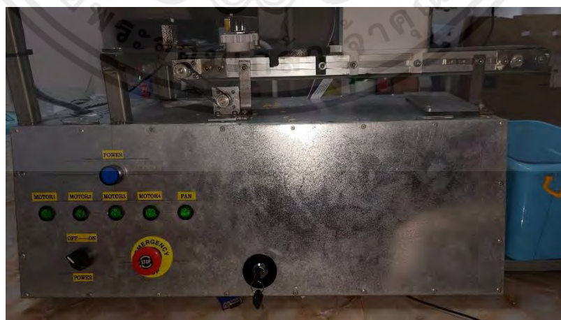
รูปที่ 3.15 สวิตซ์ที่ติดตั้งทั้งหมดบนตัวเครื่อง
