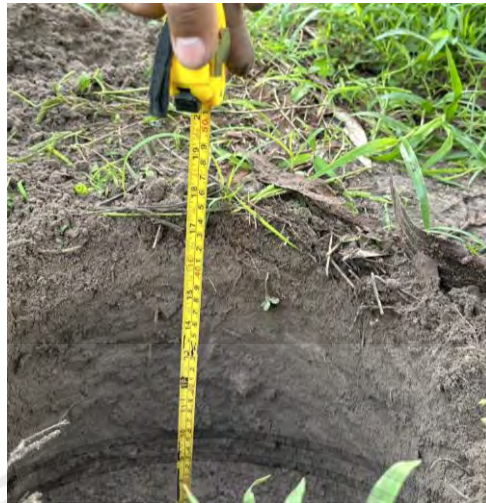
รูปที่ 4.7 การเจาะดินร่วนระยะความลึก 40 เซนติเมตร
