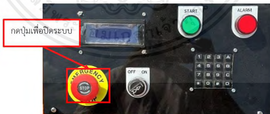
รูปที่ ข.6 วิธีดับเครื่องยนต์และระบบไฟในกรณีฉุกเฉิน
