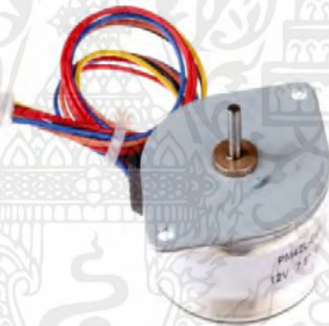
รูปที่ 2.10 สแต็ปป์มอเตอร์แบบแม่เหล็กถาวร (ที่มา: https://www.changfi.com/fix/2021/12/23/14527/ )
