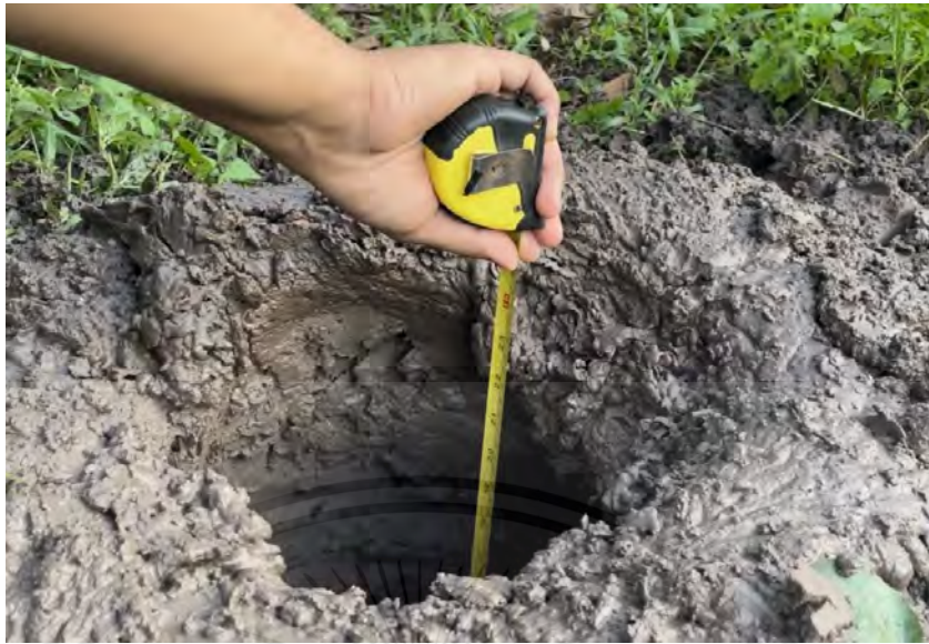
รูปที่ 4.12 การเจาะดินเหนียวระยะความลึก 50 เซนติเมตร
