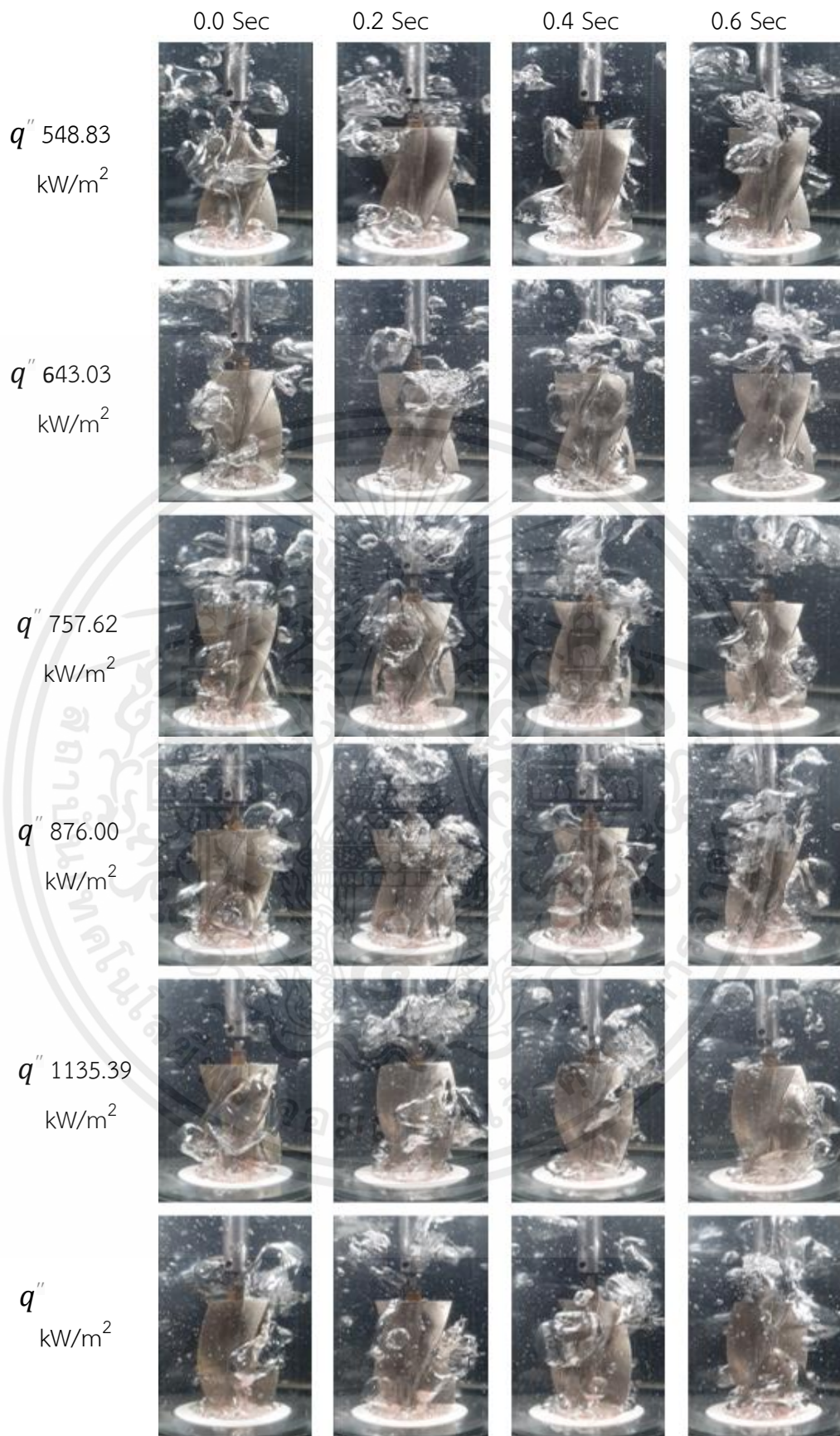
รูปที่ ๖ (ข.) ปรากฏการณ์การเดือดของ สารทำงานชนิดน้ำกลั่น ที่ติดตั้งใบ หมุนไว้เหนือพื้นผิวให้ความร้อน ที่ระยะ 5 มิลลิเมตร
