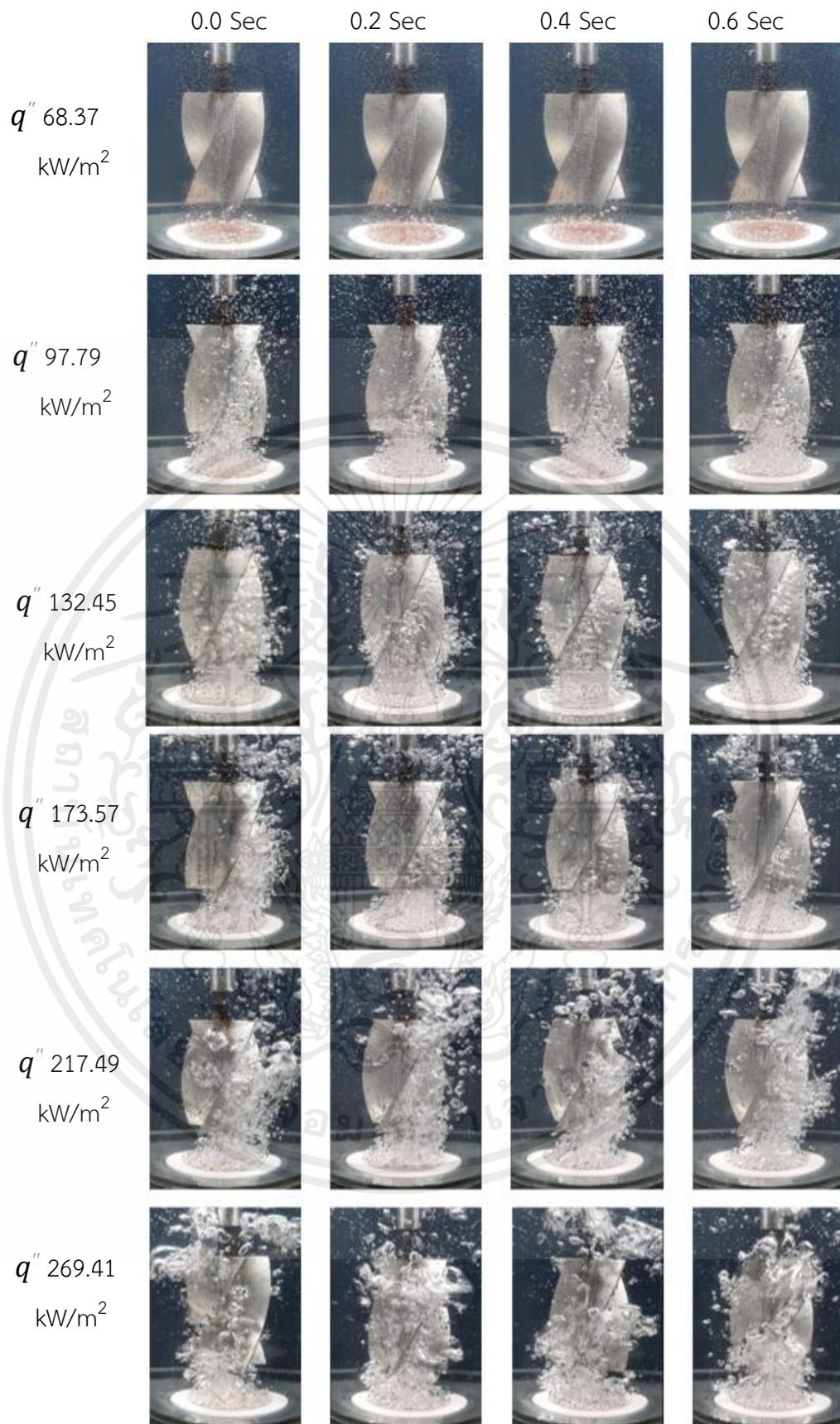
รูปที่ ง. 13 (ก.) ปรากฏการณ์การเดือดของ สารทำงานชนิดเมทานอลที่ความเข้มข้น 50 เปอร์เซ็นต์ ที่ติดตั้งไบหมุนไว้เหนือพื้นผิวให้ความร้อน ที่ระยะ 15 มิลลิเมตร
