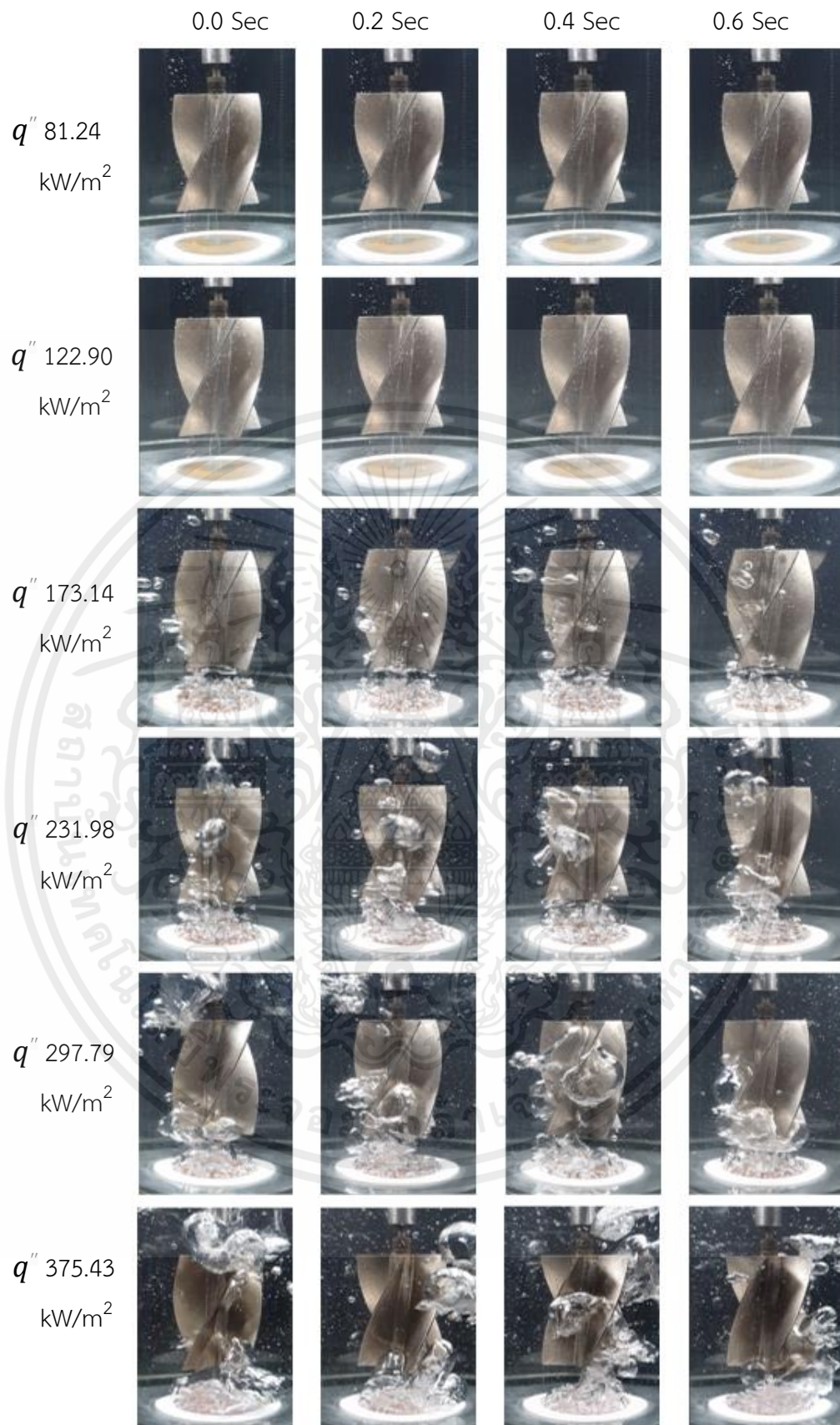
รูปที่ ง. 11 (ก.) ปรากฏการณ์การเดือดของ สารทำงานชนิดน้ำกลั่น ที่ติดตั้งใบหมุนไว้เหนือพื้นผิวให้ความร้อน ที่ระยะ 15 มิลลิเมตร
