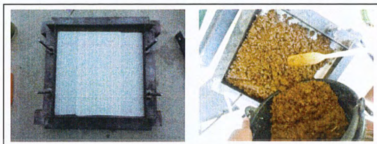
ภาพที่ 4.17 นำมาอัดใส่บล็อกพิมพ์ที่เตรียมไว้ ที่มา : (ภาพโดย อรชลลดา ทับทิมดี. 2557)
