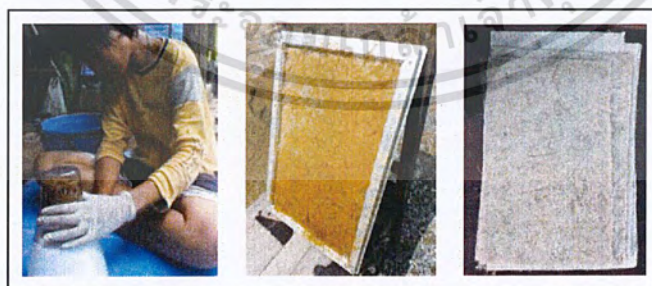
ภาพที่ 4.28 นำวัสดุทอดออกมาตากแดด เพื่อให้กาวและความชื้นแห้งสนิท ที่มา : (ภาพโดย อรชลลดา ทับทิมดี. 2556)
