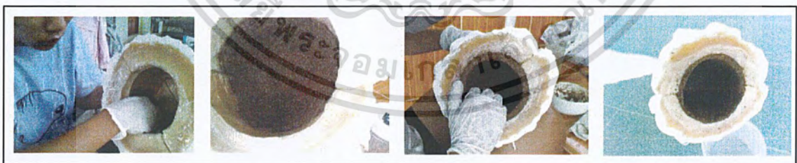
ภาพที่ 4.41 นำมาอัดเข้าพิมพ์ที่เตรียมไว้ ที่มา : (ภาพโดย อรชลดา ทับทิมดี. 2558)
