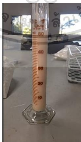
ภาพ ค.4 ภาพตัวอย่างของผงโฟม-แมทจากกึ่งหลังนำไปอบแล้ว
