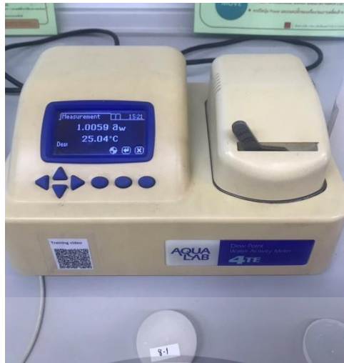
ภาพที่ ข.2 เครื่องวัดวอเตอร์แอกทีวิตี (Water Activity ( a_w ) AQUA LAB รุ่น 4TE )
