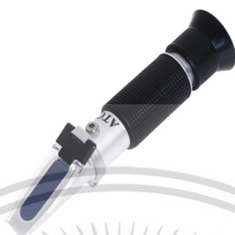
ภาพที่ ข.1 เครื่องวัดค่าความหวาน (Brix Refractometer)
