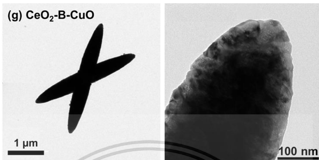
รูปที่ 4.10 ภาพถ่าย TEM ที่กำลังขยายต่างกันของตัวเร่งปฏิกิริยา (g) \text{CeO}_2\text{-B-CuO}
