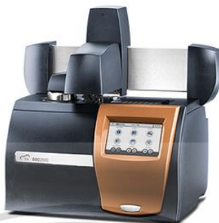
รูปที่ 2.15 เครื่องดีพีเพอเรนเชียลสแกนนิ่งแคลอริมิเตอร์ รุ่น Discovery DSC25
