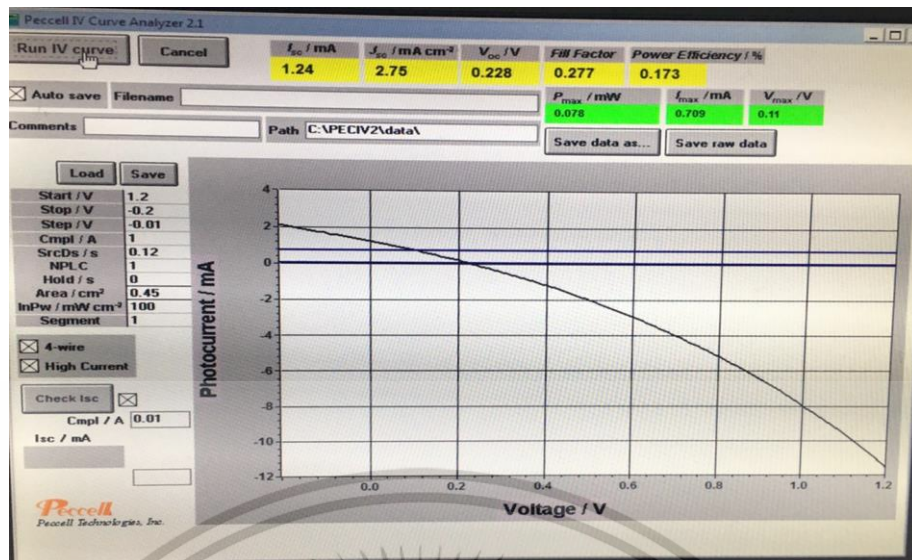
รูปที่ 4.13 ตัวอย่าง Peccell IV curve ของเซลล์แสงอาทิตย์เพอรอฟสไกต์ที่มีความเข้มข้นของไทเทเนียมไดออกไซด์ 1.27 wt% ซึ่งทำการวิเคราะห์ผลด้วย โปรแกรม Peccell IV curve analyzer
