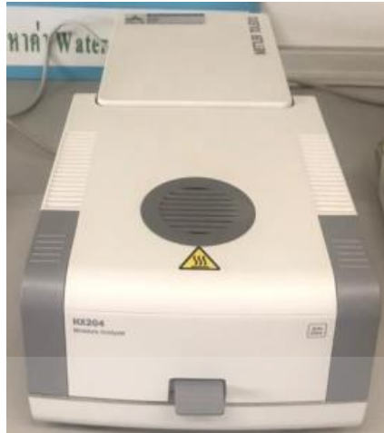
ภาพที่ ข3 เครื่องวัดค่าปริมาณความชื้น (Moisture Halogen Metter : Toledo รุ่น HX204)
