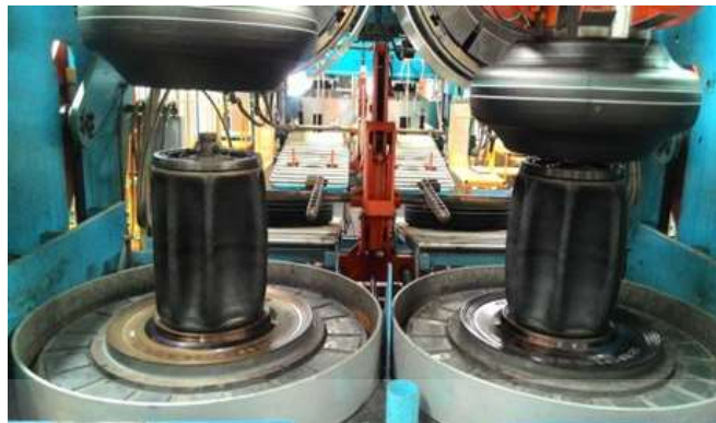
รูปที่ 2.16 ถูกลมยาง และกรีนไทร์ที่ประกอบเข้ากับแม่พิมพ์เพื่อทำการขึ้นรูป [8]
