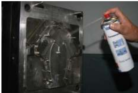
รูปที่ 2.6 การพ่น (Spraying) [19]
