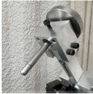
รูปที่ 2.19 หัวกดลูกบอลทั้งสแตนคาร์ไบด์ของเครื่องไทรโบมิเตอร์
