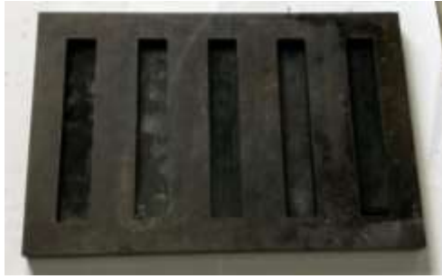
รูปที่ 3.6 แม่พิมพ์เหล็กสำหรับใช้ในการทดสอบการถอดแบบ
