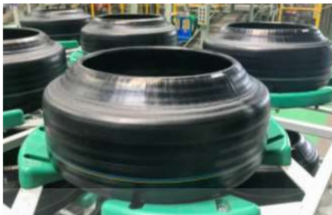
รูปที่ 1.1 กรีนไทร์ (Green tire) [4]
