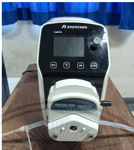
รูปที่ 3.2 ปัมดูดจ่ายสารแบบรีดท่อ (Peristaltic pump)
