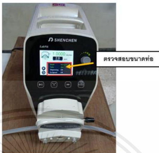
รูปที่ 3.6 การตรวจสอบขนาดของท่อที่ใช้งาน
