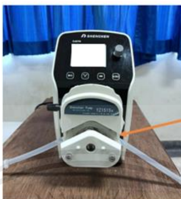
รูปที่ 3.4 การติดตั้งท่อซิลิโคนตามขนาดที่ต้องการ
