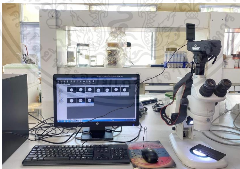
รูปที่ 3.17 ใช้กล้องจุลทรรศน์ส่องดูลักษณะภายนอกและภายในของรูเจาะ
