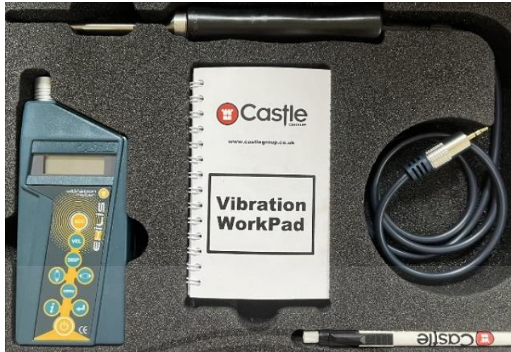
รูปที่ 2.9 เครื่องวัดการสั่นสะเทือน (Vibration Meter)
