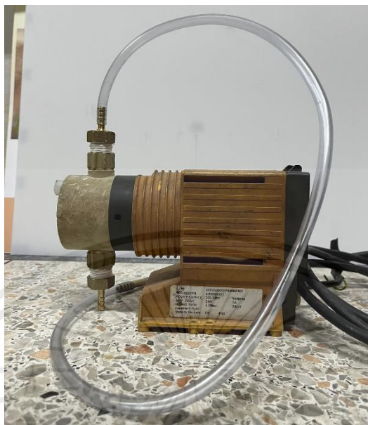
รูปที่ 3.11 ป้อนจ่ายสารเคมี (Dosing pump)
