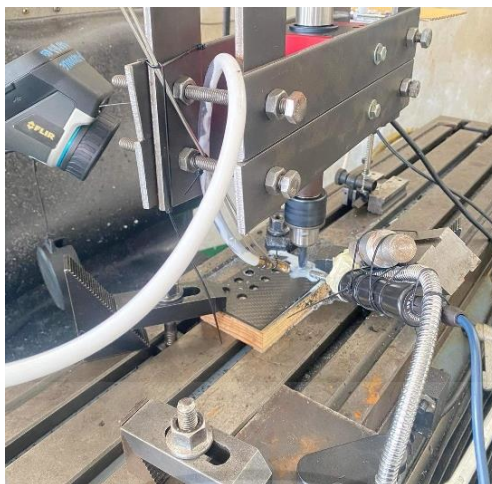
รูปที่ 3.16 เริ่มทำการเจาะแผ่นคาร์บอนตามเงื่อนไขที่กำหนด
