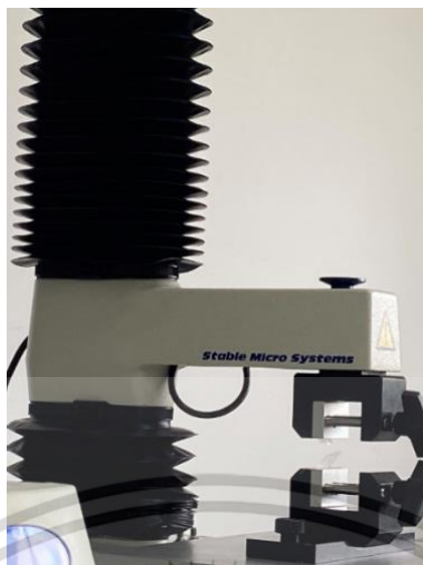
ภาพภาคผนวกที่ ค.2 เครื่องวิเคราะห์เนื้อสัมผัสรุ่น TA.XTPlus
