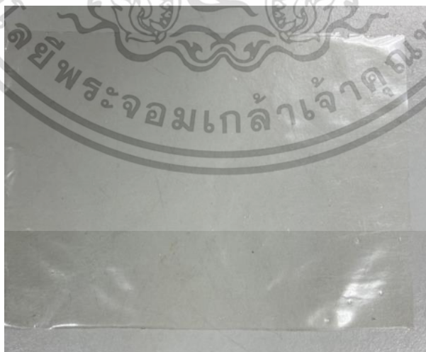
ภาพภาคผนวกที่ ข.8 นำเข้าเครื่องอบเจด ที่อุณหภูมิ 37.5 °ซ เป็นเวลา 6 ชม.
