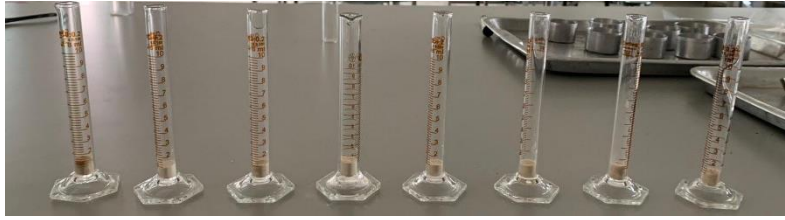
ภาพที่ ก.9 การวิเคราะห์ค่าความหนาแน่นรวม (Bulk density) และความหนาแน่นแบบเคาะ (Tapped density) ของผงโพลี-แมทหลังการอบแห้ง
