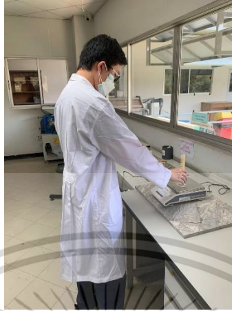
ภาพที่ ก.3 การวิเคราะห์ค่าความหนาแน่นของโพน-แมทก่อนการอบแห้ง
