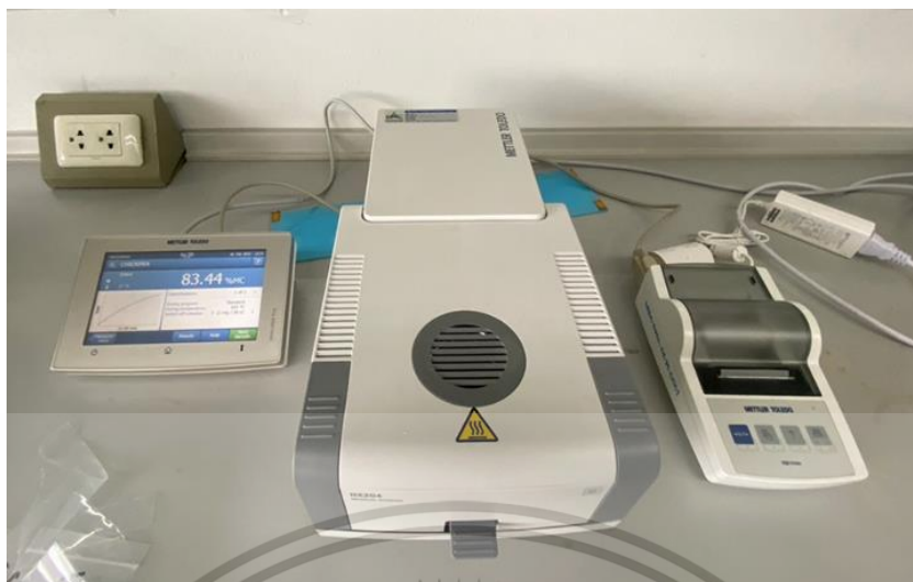
รูปที่ ก.3 เครื่องวัดความชื้น (Moisture halogen) ยี่ห้อ Mettler Toledo : รุ่น HX204
