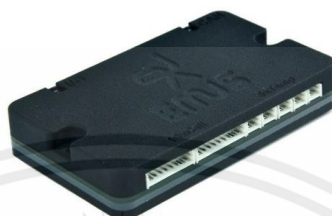
รูปที่ 3.9 Centralized CAN group module
