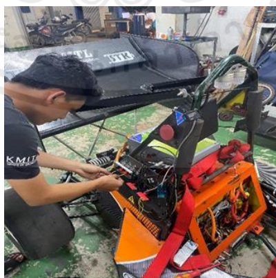
รูปที่ 4.5 ตัวอย่างการทดสอบความถูกต้องของวงจร Shutdown Circuit ของรถตาม
