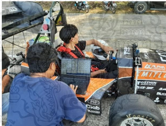
รูปที่ 3.33 การตั้งค่าจำกัดการจ่ายกระแสไฟฟ้า
