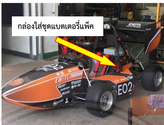
รูปที่ 3.11 ตำแหน่งการจัดวางกล่องใส่ชุดแบตเตอรี่แพ็ค
