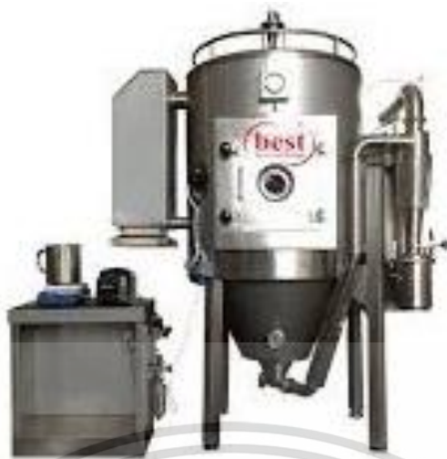
ภาพที่ 2.2 เครื่องทำแห้งแบบพ่นฝอย SDE-10 Euro 2
