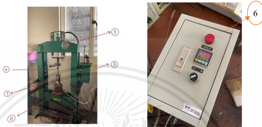
รูปที่ 3.2 องค์ประกอบของเครื่องอัดเม็ดชีวมวล
