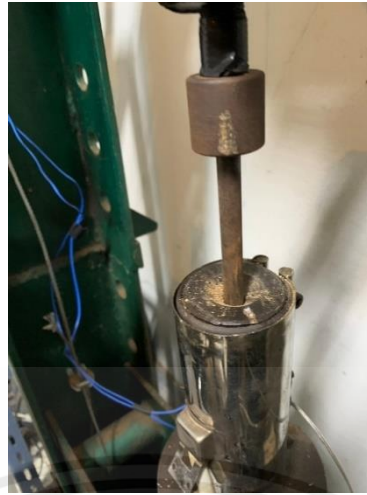
รูปที่ ก.5 ทำการอัดเม็ดใบยาพารากับซีลี้อย่างพารา
