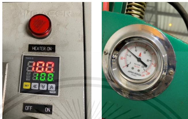
รูปที่ 3.6 เกจบอกความดันในกระบอกไฮดรอลิกส์
