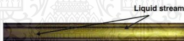
รูปที่ 2.15 Annular-rivulet flow Saisorn et al. [3]
