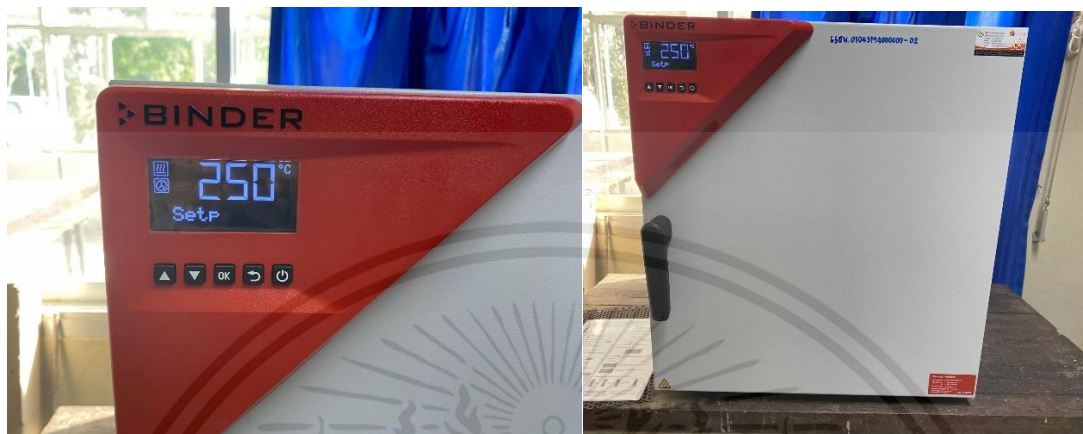
รูปที่ 3.14 เตาอบที่อุณหภูมิ 250 องศาเซลเซียส
