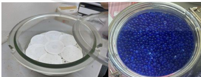
รูปที่ 3.13 นำแผ่นกระตาศกรองไปแช่ซิลิกาเจลเป็นเวลา 24 ชั่วโมง
