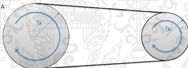
รูปที่ 2.10 ชุดส่งกำลังตัวขับ A ส่งกำลังผ่านสายพาน ไปยังตัวตาม B [15]
