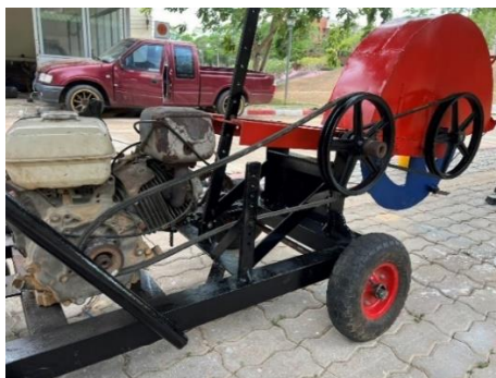
รูปที่ 3.23 ติดตั้งพ่วงอยู่กับสายพาน
