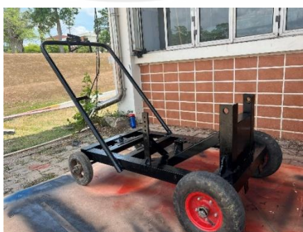
รูปที่ 3.7 โครงสร้างเครื่องเปิดร่องดินเกษตรรอนเนกประสงค์
