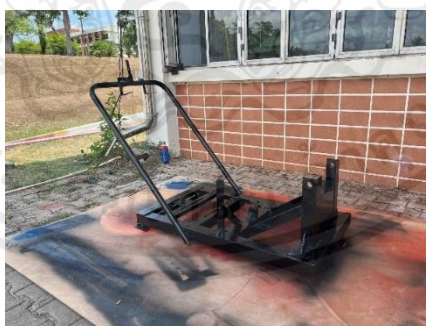
รูปที่ 3.4 โครงสร้างเครื่องเปิดร่องดินเกษตรอเนกประสงค์
