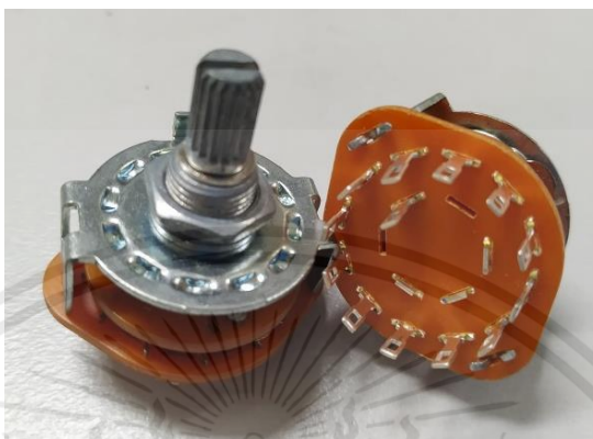
รูปที่ 3.17 สวิตช์แบบหมุน (Rotary switch)12 ช่อง
