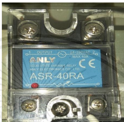
รูปที่ 3.13 โซลิตสเตรียลย์ (Solid state relay) 40A ASR-40RA
