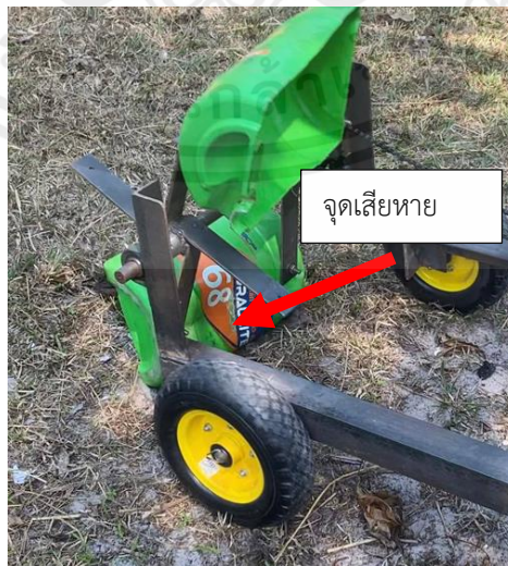
รูปที่ 4.1 ใบเก็บแบบที่ 1 ที่เสียรูป
