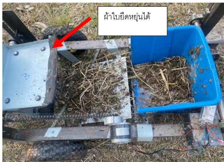
รูปที่ 4.3 การทดสอบใบเก็บมูลโค
