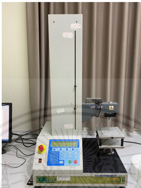
รูปที่ 3.46 เครื่องทดสอบเนื้อสัมผัส ยี่ห้อ LLOYD Instrument รุ่น TAPLUS
