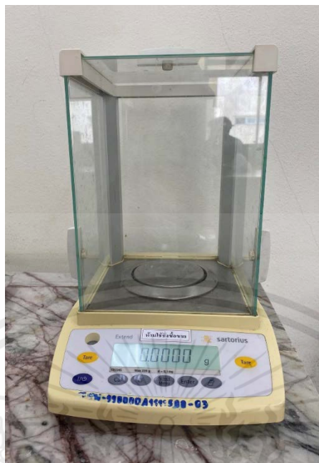
รูปที่ 3.40 เครื่องชั่งน้ำหนักดิจิทัล ยี่ห้อ Sartorius รุ่น ED224S
