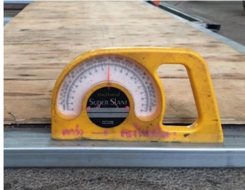
รูปที่ 3.22 ติดตั้งระดับน้ำแบบงานองศาที่แทนทดสอบการเอียง
