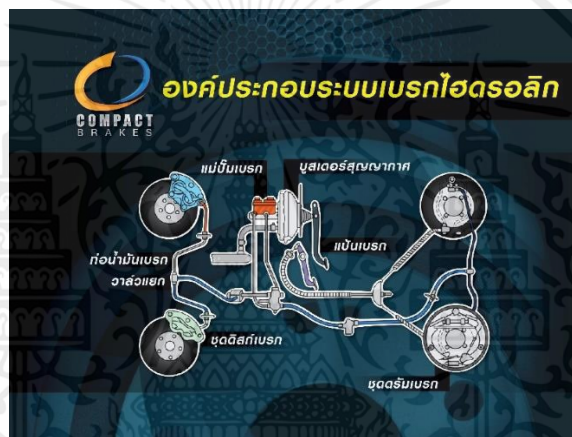
รูป 2.11 องค์ประกอบระบบเบรกไฮดรอลิก ที่มา Compactbrakes [11]
