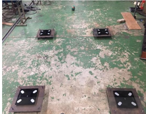
รูปที่ 3.26 ติดตั้งตาชั่งดิจิตอลบนแท่นระดับ
