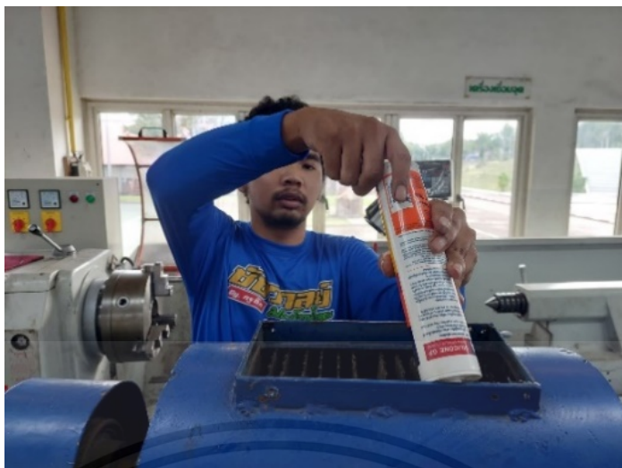
รูปที่ 3.9 ใช้กาซิลิโคนอุดช่องว่าง
