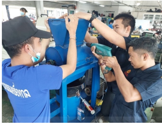
รูปที่ ก.3 ยึดชิ้นส่วนที่มีเสียงดังให้แน่นขึ้น
