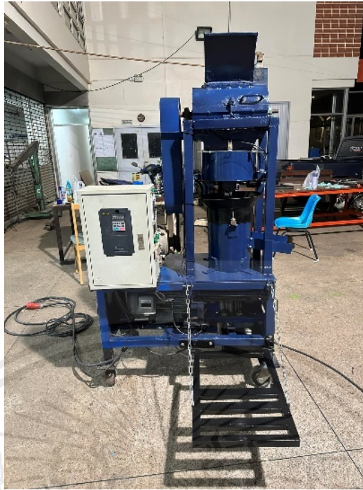
รูปที่ 3.11 เครื่องบดและอัดเม็ดชีวมวลที่ติดตั้งชุดเพิ่มความชื้นแล้ว
