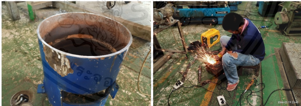
รูปที่ ก.4 ทำการขัดและปรับตำแหน่งของชุดแม่พิมพ์ใหม่
