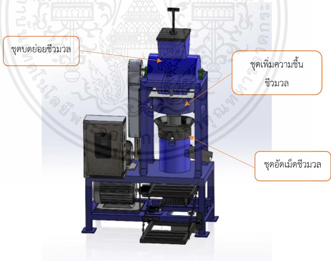
รูปที่ 3.1 การออกแบบชุดเพิ่มความชื้นของเครื่องบดและอัดเม็ดชีวมวล
