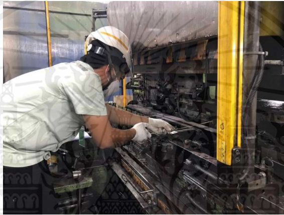
รูปที่ 3.4 วัตรระยะตำแหน่งของแม่พิมพ์โลหะที่ไลน์ผลิต ณ ปัจจุบัน
