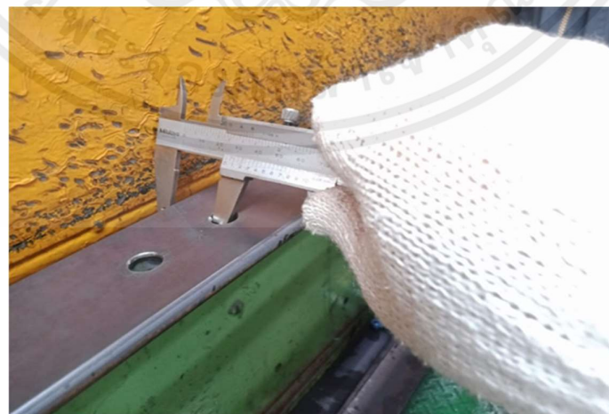
รูปที่ 3.20 วัดความเอียงของรูขึ้นงาน
