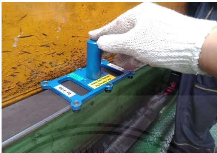
รูปที่ 3.21 วัดความโค้งมนและระยะห่างของทั้ง 2 รูชิ้นงาน
