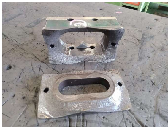
รูปที่ 4.6 ชุดใส่แป้นดอกเจาะเกิดความเสียหาย
