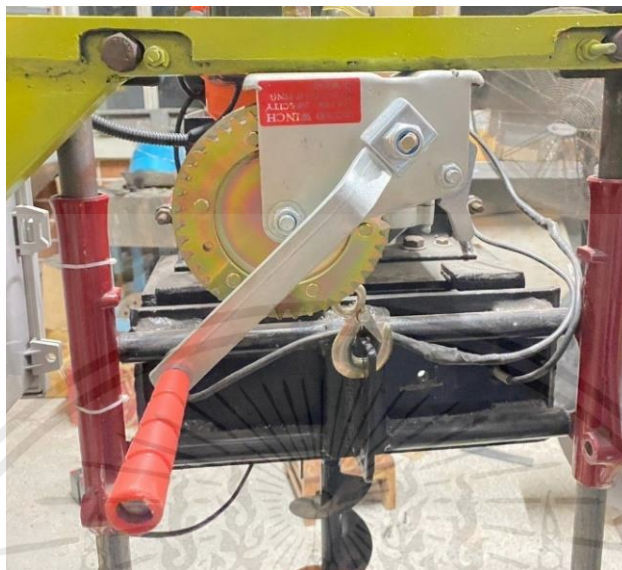
รูปที่ 3.13 ติดตั้งรอกสลิง กับตัวเครื่อง
