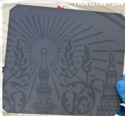
รูปที่ 2.19 ลักษณะแผ่นที่ผ่านกระบวนการเลเซอร์ [33]
