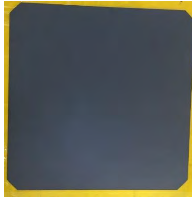
รูปที่ 2.14 ลักษณะแผ่นซิลิกอนที่ผ่านกระบวนการปรับพื้นผิว [33]
