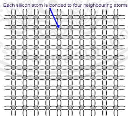
รูปที่ 2.10 โครงสร้างภายในผลึกเดี่ยว [12]
