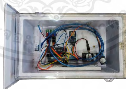
รูปที่ 3.18 เครื่องบันทึกผลอุณหภูมิโดยใช้บอร์ด Arduino UNO R3
