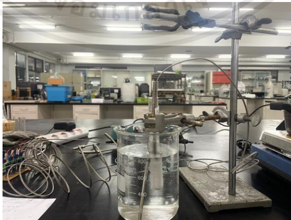
รูปที่ ค.3 การนำวัสดุเปลี่ยนเฟสไประบายความร้อนภายในน้ำ และเปลี่ยนสถานะกลับมาเป็นของแข็ง เพื่อหาความสูงของวัสดุเปลี่ยนเฟสในสถานะของแข็ง
