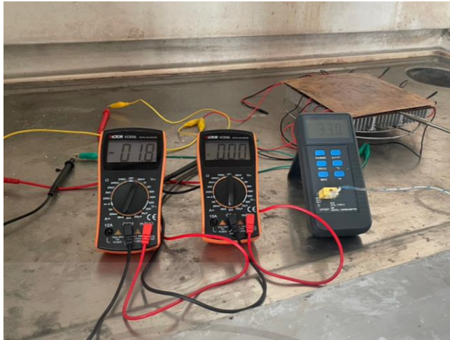
รูปที่ ค.7 การติดตั้งอุปกรณ์เครื่องกำเนิดไฟฟ้าเทอร์โมอิเล็กทริกพร้อมเครื่องมือวัด
