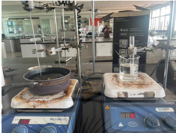
รูปที่ ค.1 การเตรียมการทดลองสำหรับการหาปริมาณที่เปลี่ยนแปลงไปของวัสดุเปลี่ยนเฟส
