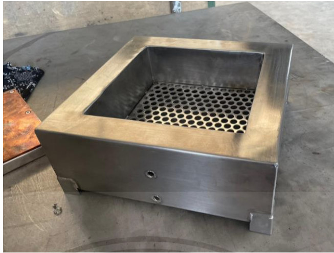
รูปที่ ค.4 ชั้นเตาเผาถ่านภายในอุปกรณ์กักเก็บพลังงานจากความร้อนเหลือทิ้ง
