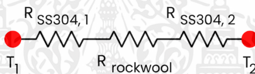
รูปที่ ก.4 วงจรความร้อนสำหรับโครงร่างของอุปกรณ์กักเก็บพลังงานเหลือทิ้งสำหรับฉนวนกันความร้อน
