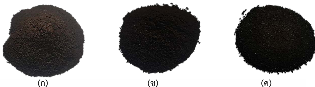
รูปที่ 4.5 ลักษณะทางกายภาพของวัสดุดูดซับ (ก) ถ่านไฮโดรดีดแปรรูปด้วย Fe^{3+} , (ข) ถ่านไฮโดรดีดแปรรูปด้วย Mg^{2+} และ (ค) ถ่านไฮโดรดีดแปรรูปด้วย Ca^{2+}
