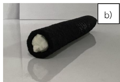
รูปที่ 4.1 ตัวอย่างชิ้นงานที่ใช้ในการทดสอบ a) แผ่นยางน้ำซึม และ b) ท่ออย่างน้ำซึม
