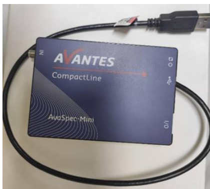
รูปที่ ก.7 เซ็นเซอร์เนียร์อินฟราเรดสเปกโตรสโกปี (AvaSpec-Mini4096CL-UV10)
