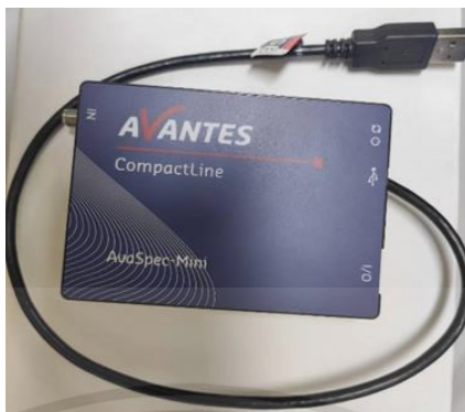
รูปที่ 3.12 เซ็นเซอร์เนียร์อินฟราเรดสเปกโตรสโกปี (AvaSpec-Mini4096CL-UV10)
