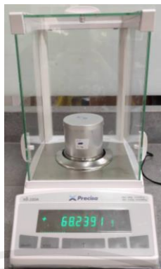
รูปที่ 3.9 เครื่องชั่งทศนิยม 4 ตำแหน่ง รุ่น Precisa Model XB 220A
