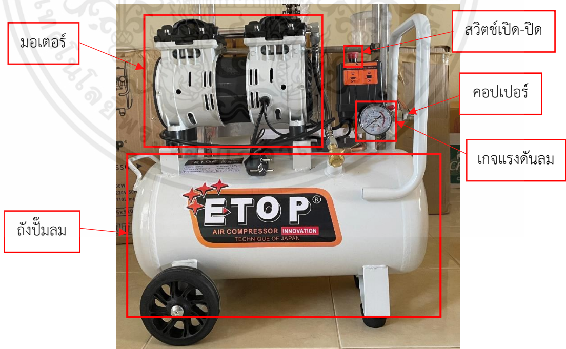
รูปที่ 3.11 ถังลมขนาด 30 ลิตร
