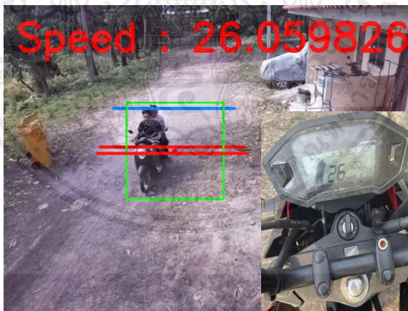
รูปที่ 4.2 ความเร็วรถที่จับได้จากกล้องตรวจจับความเร็ว 26.05 (กม./ชม.)
