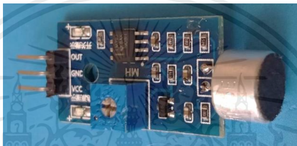
รูปที่ 2.12 โมดูลไมโครโฟนความไวสูง
