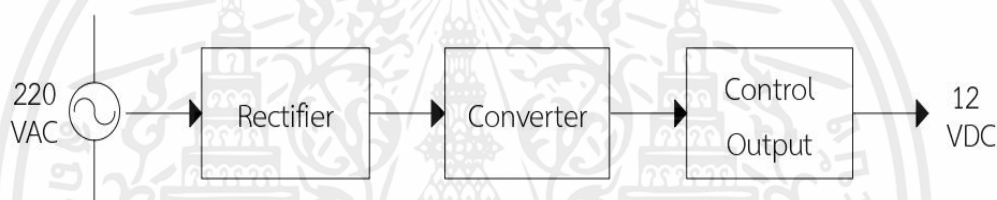
รูปที่ 2.4 หลักการทั่วไปของสวิตชิงเพาเวอร์ซัพพลาย
