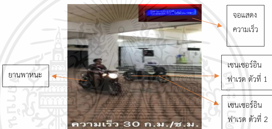
4.13 ความเร็วที่แสดงผ่านจอแอลซีดี 32.55 กิโลเมตร/ชั่วโมง
