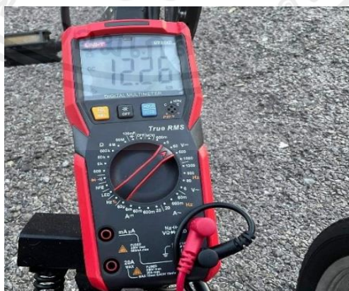
รูปที่ 4.17 ปั่นที่ความเร็วคงที่ 15 กิโลเมตร/ชั่วโมง แบตเตอรี่ 12 โวลต์ ใน 10 นาทีแรกแรงดันที่วัดได้ 12.26 โวลต์
