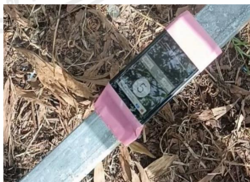
รูปที่ 4.14 เมื่อพบความชัน 5 องศา ระบบช่วยในการขับเคลื่อนไม่ทำงาน ไฟโซลิตสเตรรี่เลย์ไม่ติด
