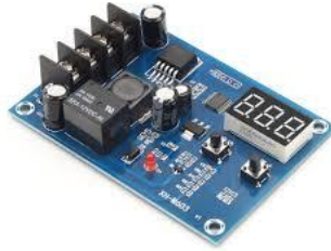
รูปที่ 2.9 ตัวอย่างโมดูลควบคุมวงจรชาร์จแบตเตอรี่ 12-24 โวลต์ ที่มา ( http://www.dropshipsmile.com/ )
