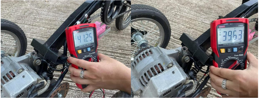
รูปที่ 4.24 ครั้งที่ 3 แรงดันเมื่อเริ่มปั่น 41.25 โวลต์ เมื่อปั่นครบ 5 กิโลเมตร แรงดันลดลงเหลือ 39.63 โวลต์
