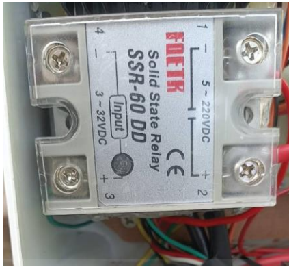
รูปที่ 4.15 เมื่อพบความชื้น 10 องศา ระบบช่วยในการขับเคลื่อนไม่ทำงาน ไฟโซลิตสเตตรีเลย์ไม่ติด
