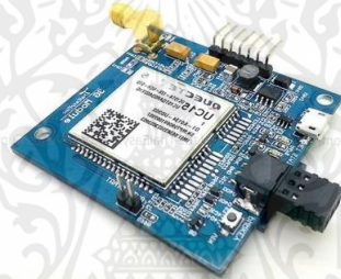
รูปที่ 2.14 3G Module (UC15-T) (ที่มา https://www.thaieasyelec.com/ )
