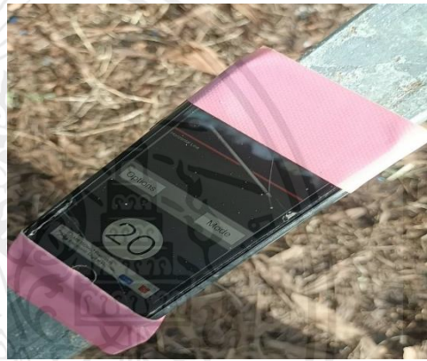
รูปที่ 4.16 เมื่อพบความชื้น 20 องศา ระบบช่วยในการขับเคลื่อนทำงาน ไฟโซลิตสเตตรีเลย์ติด
