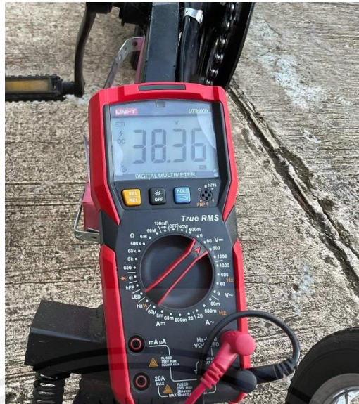
รูปที่ 4.21 เมื่อปิดต่อเนื่องที่ความเร็วคงที่ 15 กิโลเมตร/ชั่วโมง แบตเตอรี่ 36 โวลต์ ใน 30 นาที แรงดันที่วัดได้ 38.36 โวลต์
