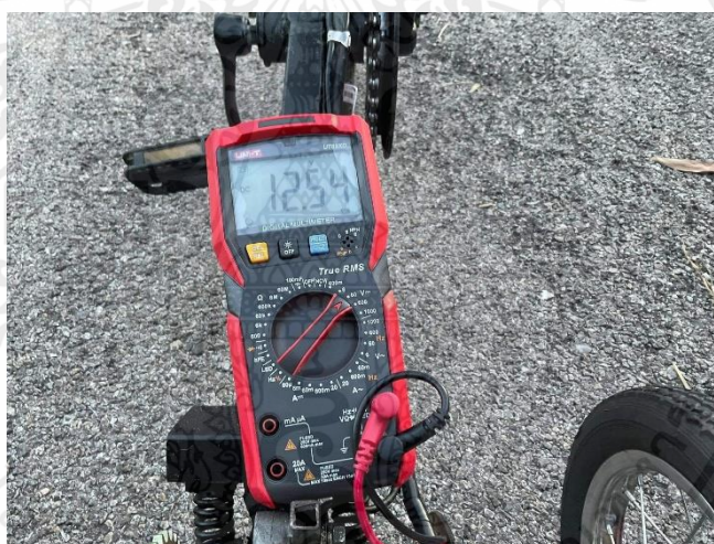
รูปที่ 4.19 ปั่นที่ความเร็วคงที่ 15 กิโลเมตร/ชั่วโมง แบตเตอรี่ 12 โวลต์ ครบ 60 นาที แรงดันที่วัดได้ 12.54 โวลต์
