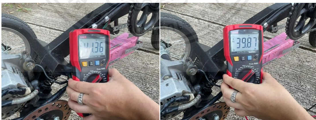
รูปที่ 4.23 ครั้งที่ 1 แรงดันเมื่อเริ่มปั่น 41.36 โวลต์ เมื่อปั่นครบ 5 กิโลเมตร แรงดันลดลงเหลือ 39.87 โวลต์
