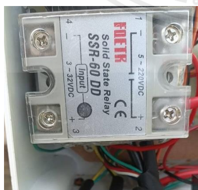
รูปที่ 4.14 เมื่อพบความชัน 5 องศา ระบบช่วยในการขับเคลื่อนไม่ทำงาน ไฟโซลิตสเตรรี่เลย์ไม่ติด
