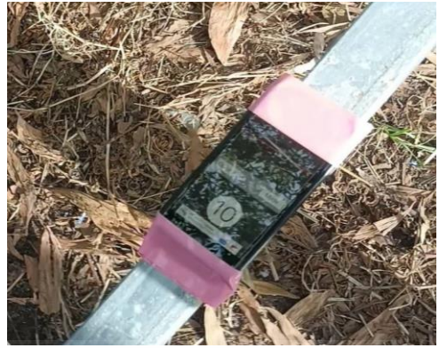
รูปที่ 4.15 เมื่อพบความชื้น 10 องศา ระบบช่วยในการขับเคลื่อนไม่ทำงาน ไฟโซลิตสเตตรีเลย์ไม่ติด
