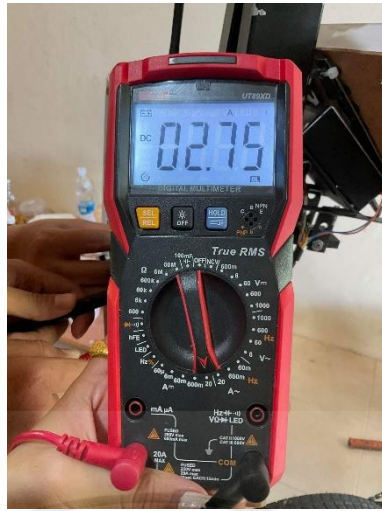
รูปที่ 4.11 ภาระทางไฟฟ้าในช่วง 50 โอห์ม กระแสทางด้านอินพุต 2.75 แอมป์
