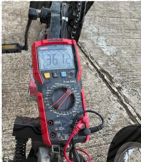
รูปที่ 4.22 เมื่อปิดต่อเนื่องที่ความเร็วคงที่ 15 กิโลเมตร/ชั่วโมง แบตเตอรี่ 36 โวลต์ ใน 40 นาที แรงดันที่วัดได้ 36.12 โวลต์
