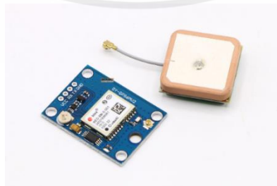
รูปที่ 2.16 GPS Module GY-NE06MV2 Ublox (ที่มา http://www.iot.codemobiles.com/ )
