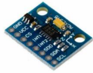
รูปที่ 2.18 Gyroscope sensor (ที่มา http://www.indiamart.com )
