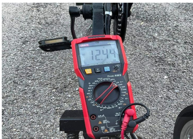
รูปที่ 4.18 ปั่นที่ความเร็วคงที่ 15 กิโลเมตร/ชั่วโมง แบตเตอรี่ 12 โวลต์ ใน 40 นาที แรงดันที่วัดได้ 12.44 โวลต์
