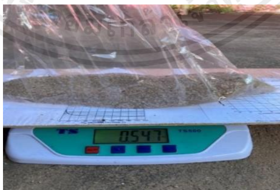
รูปที่ 4.17 ภาพการชั่งปุ๋ยเมื่อจ่ายปุ๋ย 500 กรัม
