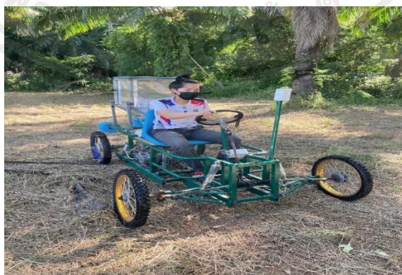
รูปที่ 4.2 การขับเคลื่อนรถใส่ปุ๋ยปาล์มกึ่งอัตโนมัติในพื้นที่ราบ180องศาในสวนปาล์ม
