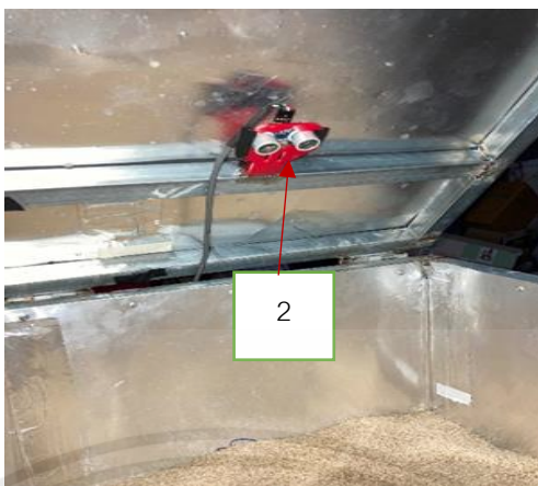
รูปที่ 3.13 เซนเซอร์อัลตราโซนิกวัดปริมาณปุ๋ยในถัง
