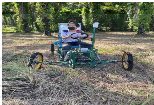
รูปที่ 4.3 การขับเคลื่อนรถใส่ปุ๋ยปาล์มกึ่งอัตโนมัติในพื้นที่ลาดชันในสวนปาล์ม
