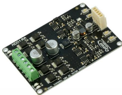
รูปที่ 2.10 บอร์ดขับมอเตอร์ไฟกระแสตรง 2 ช่อง 10 แอมป์
