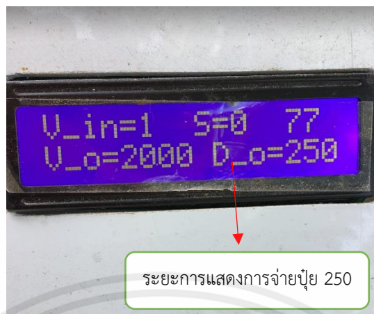
รูปที่ 4.12 ภาพจอแอลซีดีแสดงระยะห่างในการจ่ายปุ๋ย 250 เซนติเมตร
