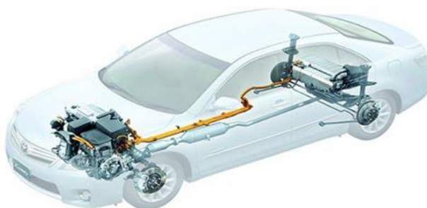
รูปที่ 2.1 ตัวอย่างยานยนต์ไฟฟ้าไฮบริด (Hybrid Electric Vehicle HEV)
