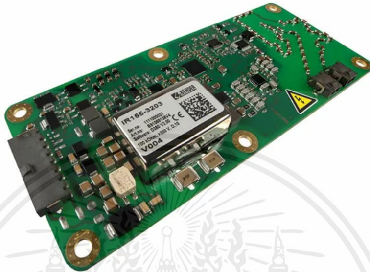
รูปที่ 3.16 แผงวงจร ISOMETER ® iso-F1 IR155-3203 / -3204
