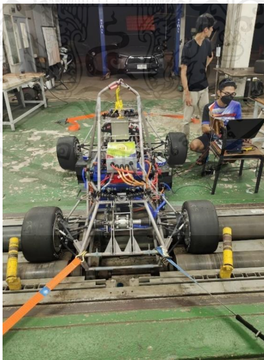
รูปที่ 3.43 การเอารถขึ้นบน Dyno Test
