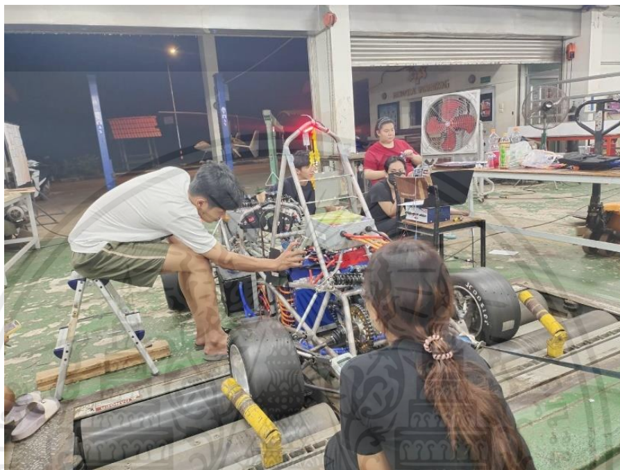
รูปที่ 3.48 การทดลองและบันทึกเวลา อุณหภูมิยาง กระแสที่ใช้ และแรงดันไฟฟ้าที่ใช้
