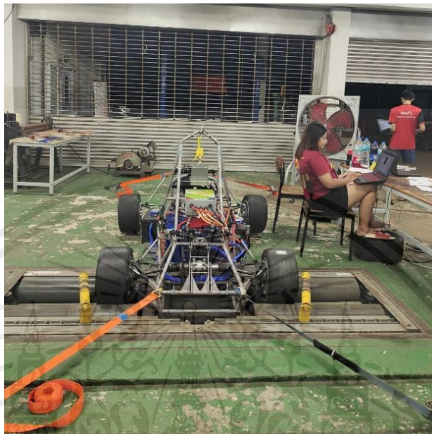
รูปที่ 3.44 การติดตั้งสายรัดสแต็กเกอร์ของ MERTRA B/S 5T×12M
