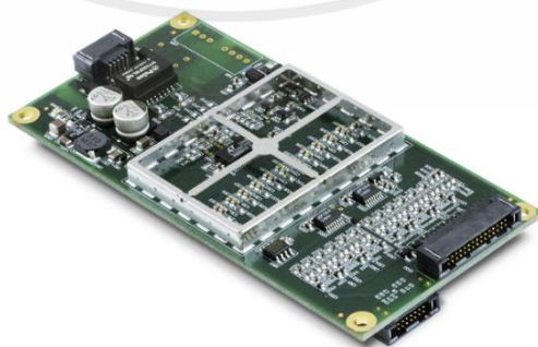
รูปที่ 2.15 Battery Management System (BMS) [แหล่งที่มา : https:// www.gtm.co.th ]
