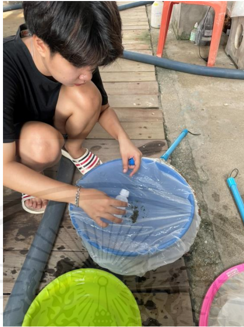
ภาพผนวกที่ 7 กรองตะกอนขังน้ำหนัก
