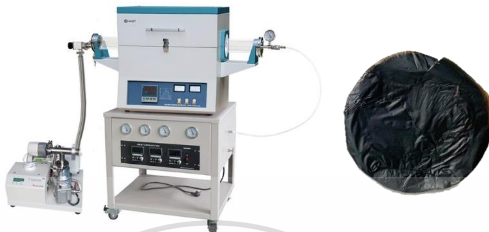
รูปที่ 3.2 เครื่องมือที่ใช้ในกระบวนการรีดักชันด้วยความร้อนและฟิล์มรีดิวซ์กราฟีนออกไซด์ที่อยู่ได้อย่างอิสระ
