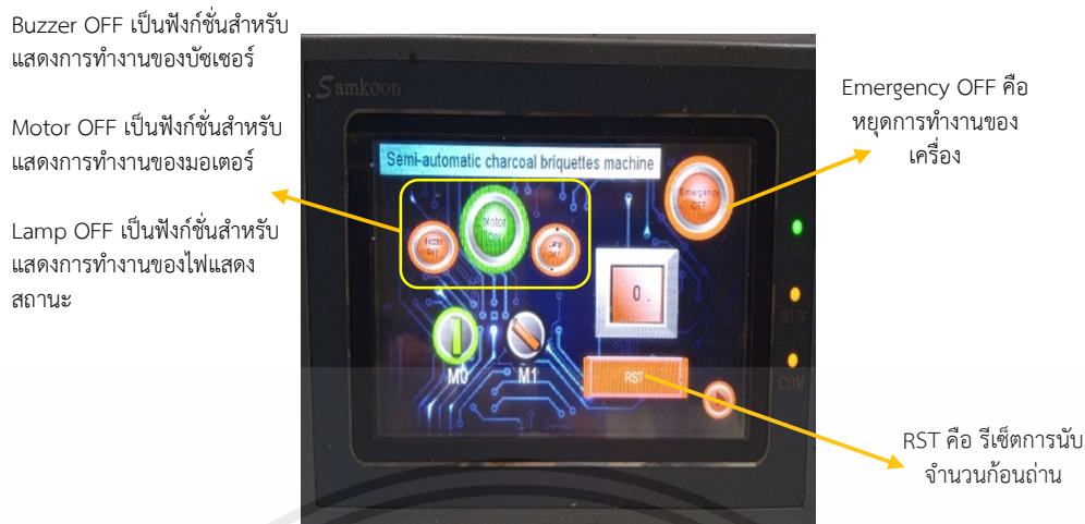
รูปที่ 4.3 การเปิดเครื่องโดยการกดสวิทช์ MO
