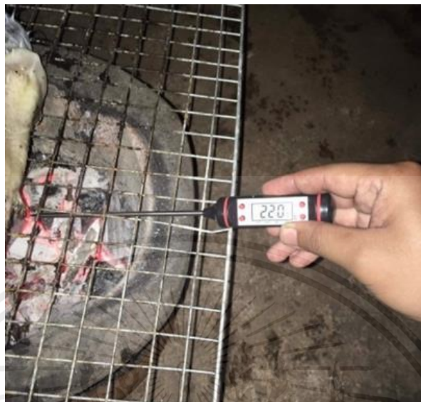
รูปที่ 4.22 วัดอุณหภูมิความร้อนของเตาถ่านอั้งโล่
