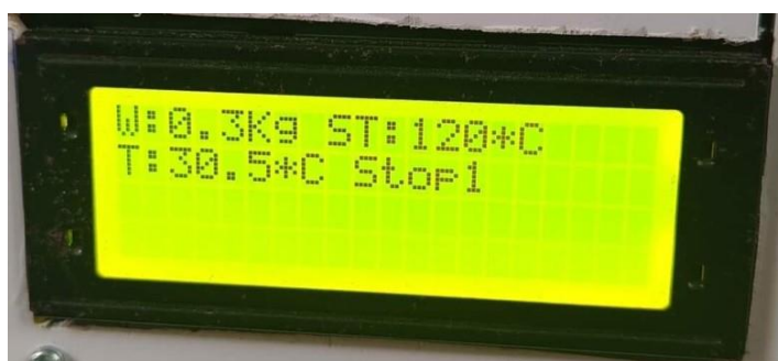
รูปที่ 4.18 หน้าจอแอลซีดีแสดงผลน้ำหนัก (ขนาดใหญ่)
