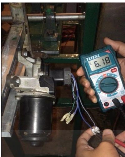
รูปที่ 4.21 การวัดแรงดันของมอเตอร์โหมตที่ 2
