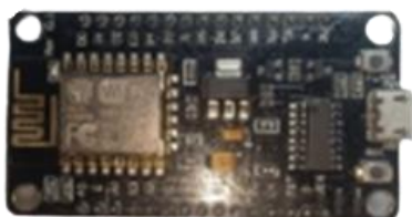
รูปที่ 2.3 บอร์ดประมวลผลโหนดเอ็มซียูอีเอสพี 8266
