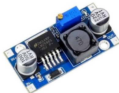
รูปที่ 2.10 วงจรลดแรงดัน
