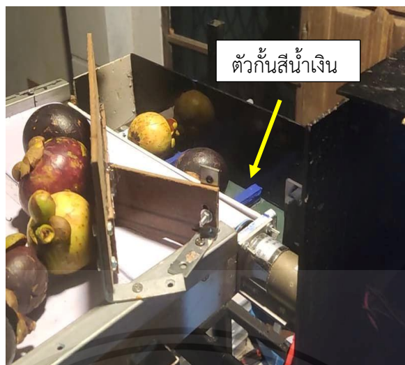
รูปที่ 3.49 ผลมังคุดที่ลำเลียงจากสายพานเส้นที่หนึ่งไปเส้นที่สอง
