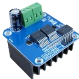
รูปที่ 2.10 บอร์ดขับมอเตอร์บีทีเอส 7960
